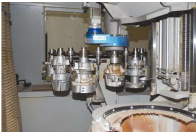
2x24 pozíciós szerszámtár a gördülékeny megmunkálás alapja
