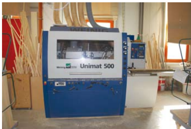
Az Unimat 500-as a fríz előkészítésért, gyalulásáért felel a technológiai sorban
