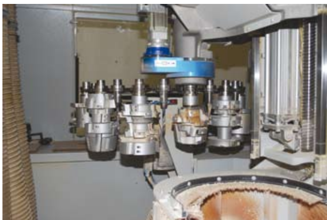
2x24 pozíciós szerszám tár a gördülékeny megmunkálás alapja
