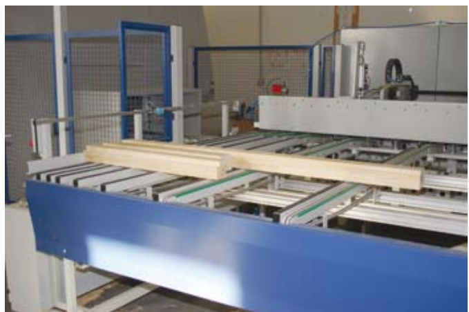
Az etetőoldali pufferzónába 40 percnyi megmunkálásra elegendő fríz tárolható be
